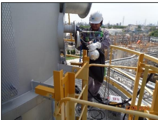
รูปที่ 4.3 การเก็บตัวอย่างคุณภาพอากาศในปล่องระบาย บริเวณปล่องของระบบ VOCs Wet Scrubber
