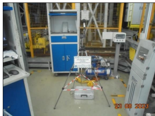
รูปที่ 4.17 การตรวจวัดระดับเสียงในพื้นที่ทำงาน บริเวณ Raw Material Warehouse
